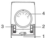
Нижний переключатель (1) имеет два положения: правое положение – отключение вентилятора, левое положение – включение вентилятора прибора
